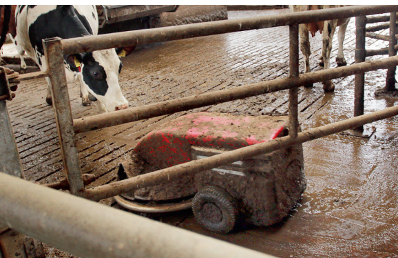
Kūtmēsli piesūmējroboti tajā ieprogrammētās darbības atkārtoti ik pēc stundas. Kūtmēsli vispirms nonāk krātuvē zem grīdas redelēm, bet vēlāk tos sūknē uz ārpus novietnes uzbūvēto krātuvī.
