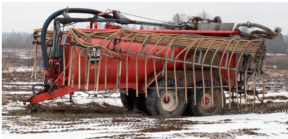
Virvas cisterna – svarīgs instruments lauku mēslošanā ar saimniecībā uz vietas ražotajiem šķidrājiem kūtsmēsliem.
